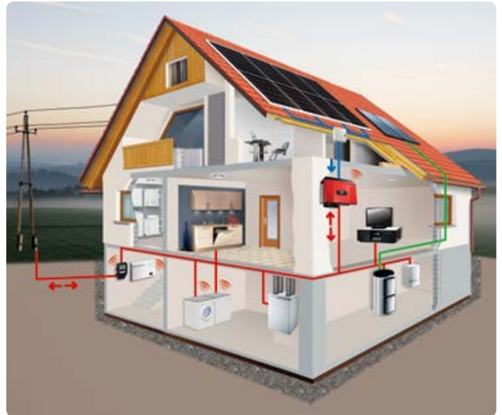
Vaillant Systemhaus mit Solarthermie und Photovoltaik
