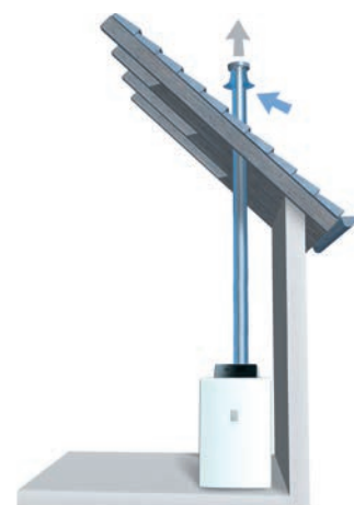
Raumluftunabhängige Aufstellvariante mit konzentrischem Luft-Abgas-System aus Kunststoff, mit Dachdurchführung
