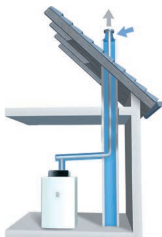
Raumluftunabhängige Aufstellvariante mit konzentrischem Luft-Abgas-System aus Kunststoff im Kamin oder Schacht
