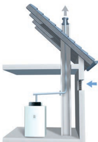
Raumluftabhängige Aufstellvariante mit eingezogenem Abgasrohr im Kamin (Zuluft über Belüftungsöffnung)
