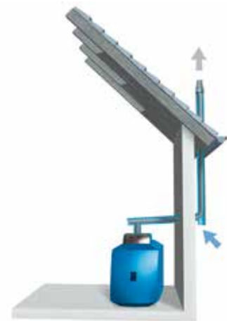
Raumluftunabhängige Aufstellvariante mit Rohr-in-Rohr-Kunststoff-Abgassystem entlang der Außenfassade
