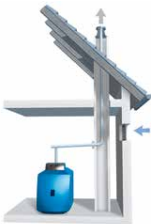
Raumluftabhängige Aufstellvariante mit eingezogenem Abgasrohr im Kamin
