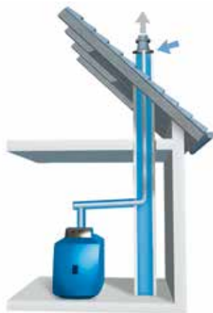
Raumluftunabhängige Aufstellvariante mit eingezogener Kunststoff-Abgasleitung im Kamin
